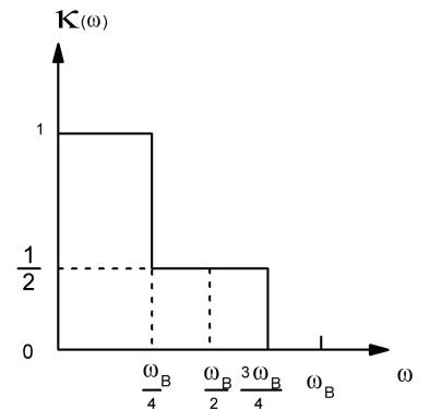
Задание. Синтезируйте КИХ-фильтр, используя метод частотной выборки ,по заданным АЧХ и ФЧХ; постройте схему фильтра. Приведите формулы для расчетов АЧХ и ФЧХ, проведите расчеты в точках взятия частотных выборок.
